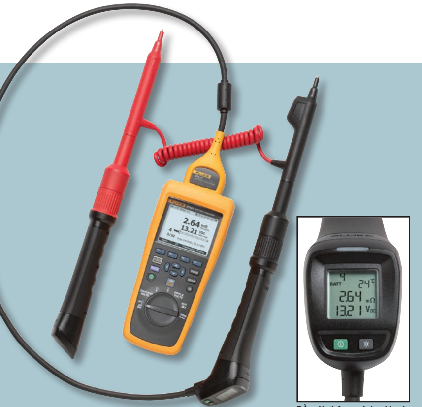
Đầu dò thông minh với màn hình hiển thị LCD tích hợp
